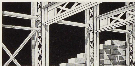
Fig. 171. Tube de contreventement et (à gauche) cadre de renforcement.
