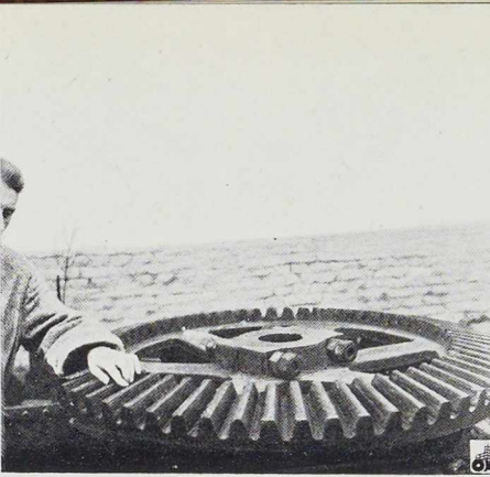
Fig. 561. Recharge à l'arc d'une denture d'engrenage.
