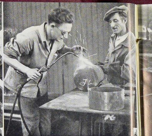
Fig. 571. Exécution d'une pièce d'épreuve au chalumeau.
