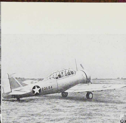
Fig. 546. Avion en acier inoxydable soudé par résistance.
