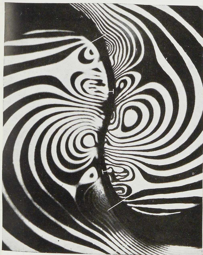
Fig. 140. Charge F = 65 kg. Largeur développée du contact 4,65 mm.
