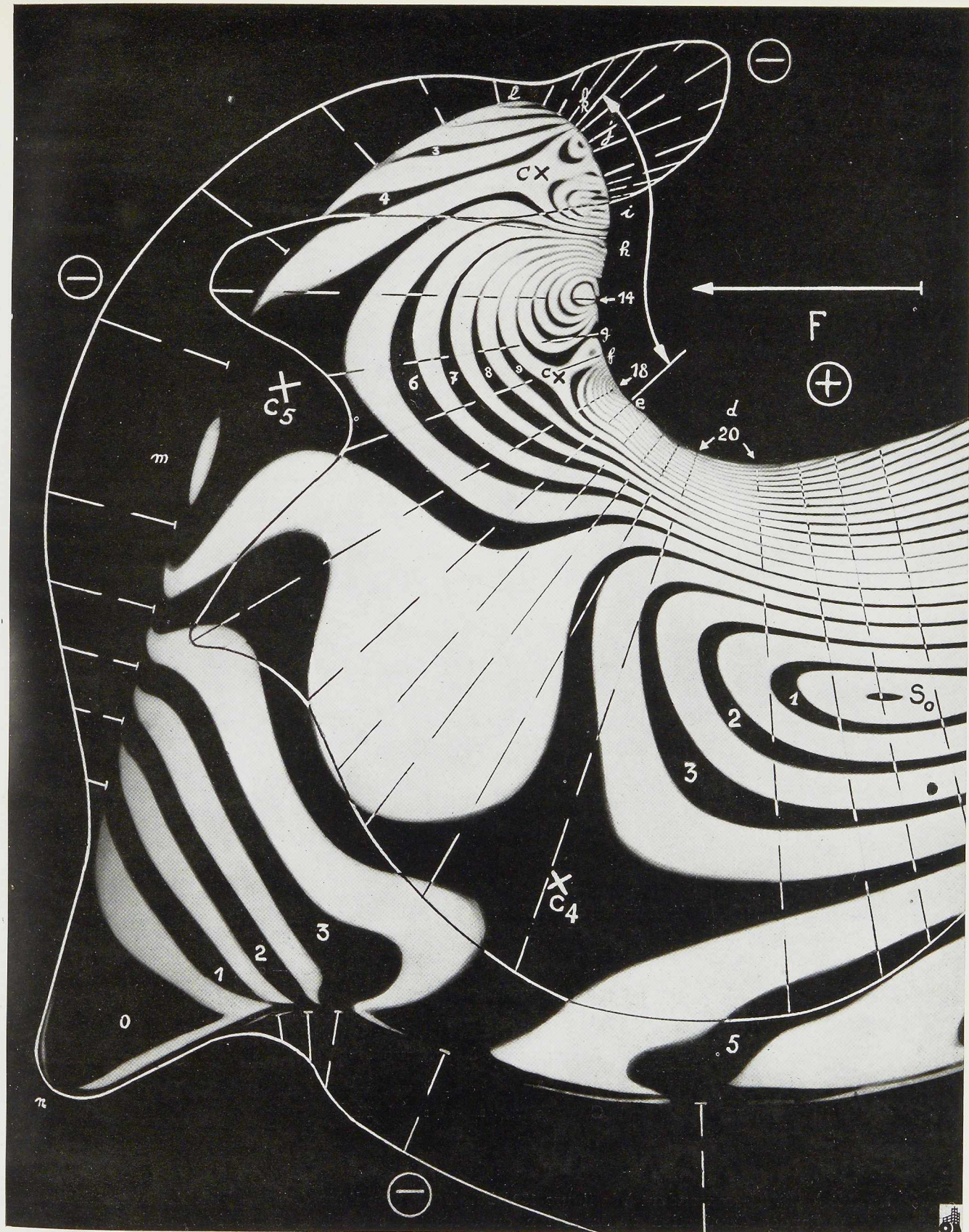
Fig. 138. Palplanches en ligne droite sollicitées par traction. Bandes d'extinction de la région de tête du crochet, agrandie 5,3 fois. Charge F = 85 kg; épaisseur de la pièce 7,6 mm; échelon de tarage t = 0,2 kg par \text{mm}^2 . (Voir figures 132 et 135 et en outre 139 et 142.)
