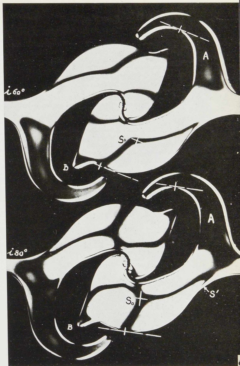
Fig. 123 à 125 (à gauche) et 126 et 127 (ci-dessus). Palplanches présentées en ligne droite, sollicitées par traction. Photographies des courbes isoclines 0°, 20°, 40°, 60°, 80°.
