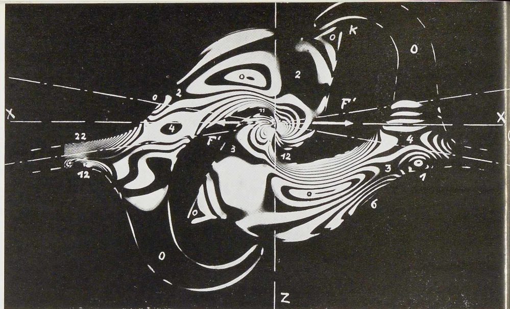
Fig. 146 (ci-dessus). Palplanches faisant entre elles l'angle maximum \alpha = 15^\circ . Bandes d'extinction. (Correspond à la figure 145.)
