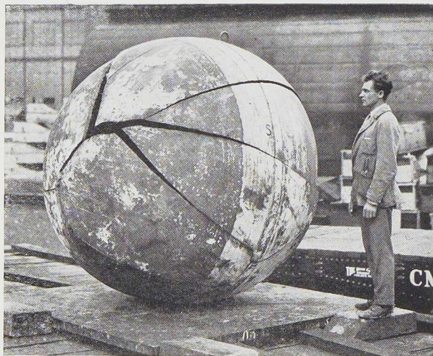
Fig. 800. Eclatement d'une sphère par pression hydraulique; cet essai réalisé à la Smith Corporation (U. S. A.) montre un cas de rupture sans déformation apparente.
