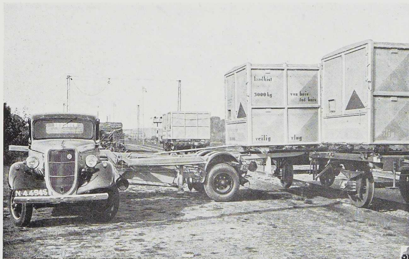
Fig. 638. Transfert d'un container de wagon sur déchargeur DAF.
