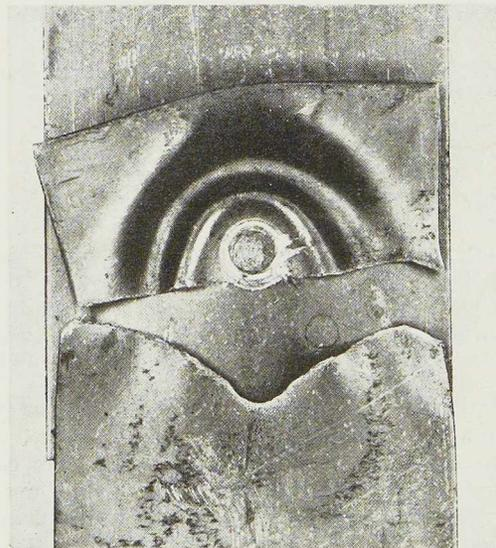
**Fig. 189.** Assemblage à 3 épaisseurs de 1 mm. Rupture du plat couvert, commencée par compression sur tranche avec voilement et achevée par traction à l'arrière du point soudé.
