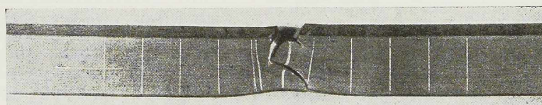
Fig. 60. Epreuve pour essai de traction comportant des cordons de soudure superficiels longitudinaux.
