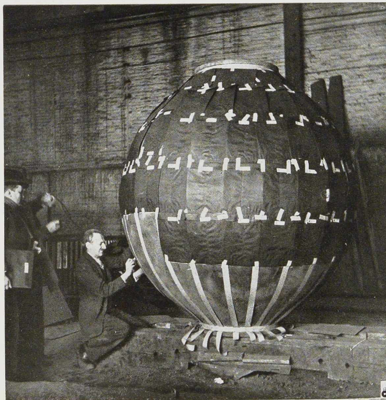
Fig. 641. Placement des films pour l'examen radiographique de la nacelle sphérique.
