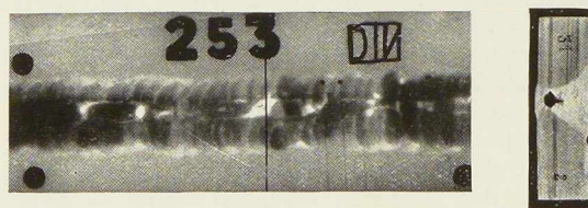
Fig. 149. Soudure verticale en V. Les taches blanches représentent d'importantes inclusions.
