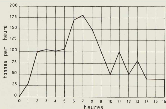
Fig. 295. Courbe caractéristique de la variation de l'extraction du charbon brut d'un siège produisant 1.300 à 1.400 tonnes par jour.
