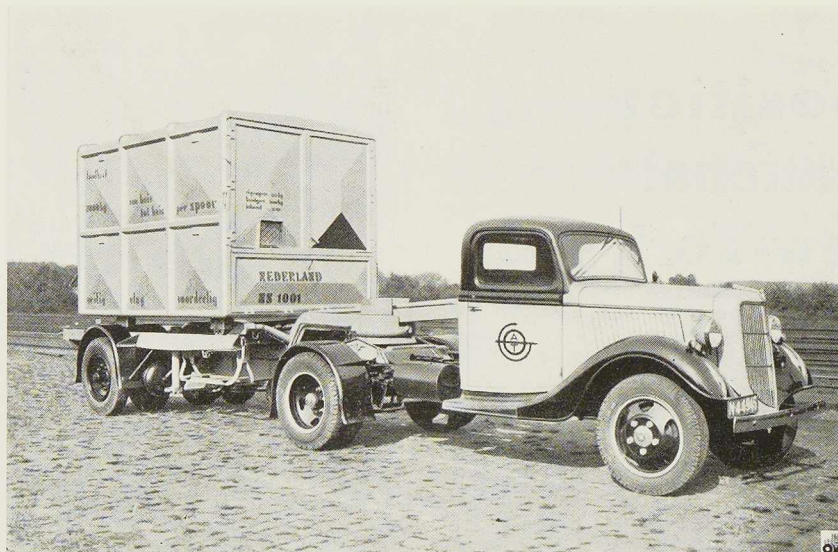
Fig. 330. Le déchargeur DAF transportant un container de 5 tonnes.
