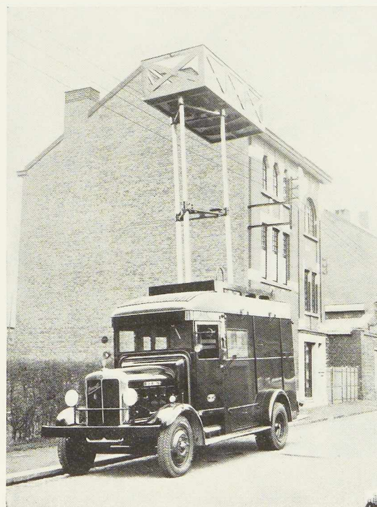
Fig. 496. Tourelle du type «Service tramways», avec plate-forme relevée.
