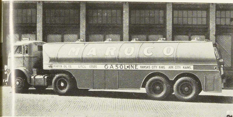
Fig. 430. Un camion-citerne en acier construit par la Columbian Steel Tank Company de Kansas City (E.-U.).
