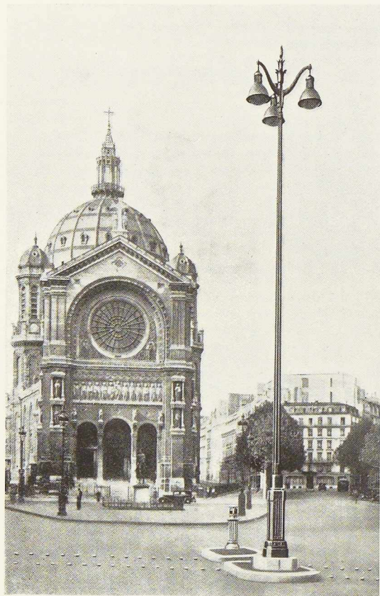
Fig. 352. Candélabre de la place Saint-Augustin à Paris. Le pylône est un tube cannelé d'un diamètre de 175 mm à la base et de 110 mm au sommet. Les lampes sont à 11 mètres de hauteur.
