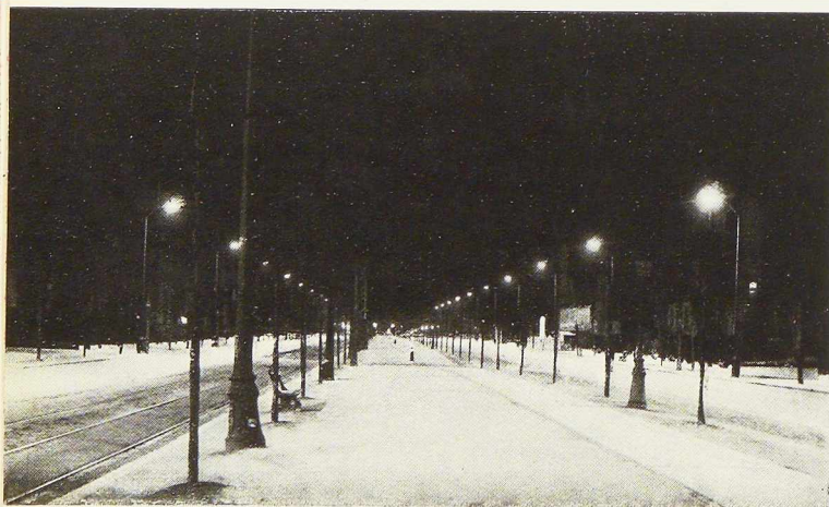
Fig. 367. Vue de nuit du boulevard Brand Whitlock à Bruxelles, éclairé par des lampes à vapeur de sodium portées par des pylônes tubulaires.
