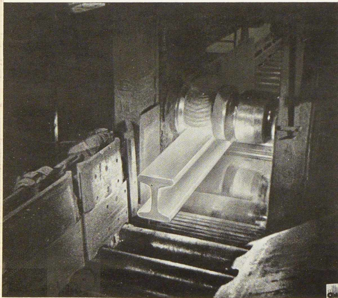
Fig. 658. Phase de laminage d'une poutrelle à larges ailes à Differdange.
