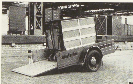
Fig. 650. Van des chemins de fer allemands chargé d'un petit container à ossature métallique et panneaux en matériaux fibreux.
