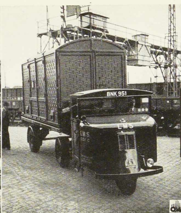
Fig. 626. Container français métallique, transporté par une remorque et un tracteur à accrochage automatique en service en Grande-Bretagne.
