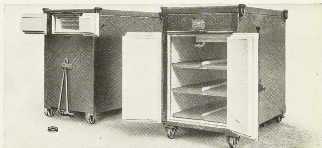
Fig. 637. Containers isothermiques munis d'une glacière, pour le transport des denrées périssables.
