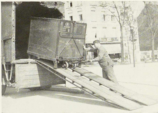
Fig. 648. Déchargement d'un petit container au moyen de plans inclinés.
