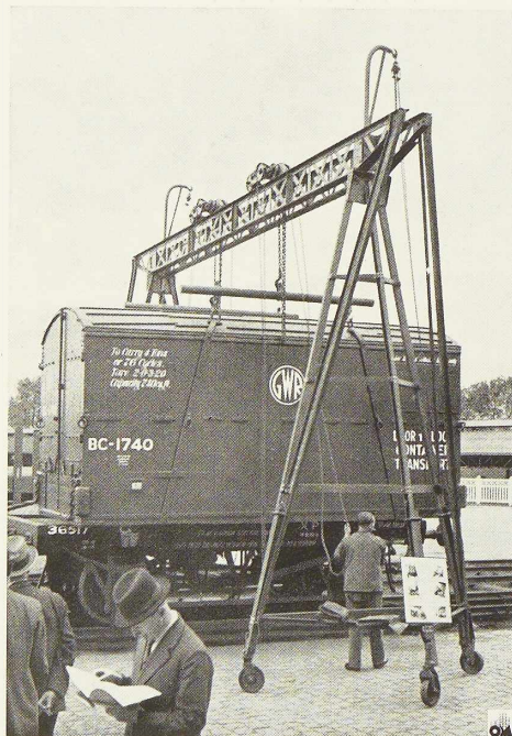
Fig. 628. Manutention d'un grand container, à ossature en acier, au moyen d'un portique démontable.
