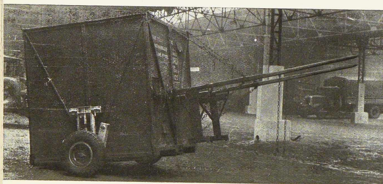
Fig. 634. Sulky, constitué par deux roues amovibles et des brancards spéciaux.
