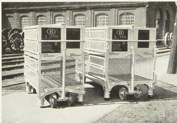
Fig. 618. Petits containers entièrement métalliques des Chemins de fer belges. Ces deux containers sont destinés au transport du petit bétail.
