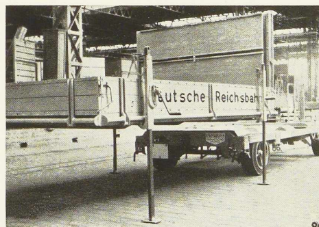
Fig. 643. Plate-forme amovible soulevée rapidement au moyen de quatre crics. On note les deux plans inclinés prévus pour le déchargement des petits containers.
