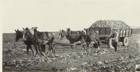
Fig. 409. Essai effectué à Gembloux : 4 chevaux déplacent un chariot tout acier pesant 8.720 kg dont 6.480 kg de charge utile.
