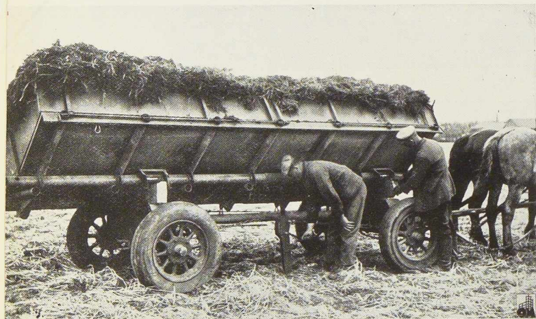
Fig. 407. Type de chariot agricole tout acier construit en Allemagne.
