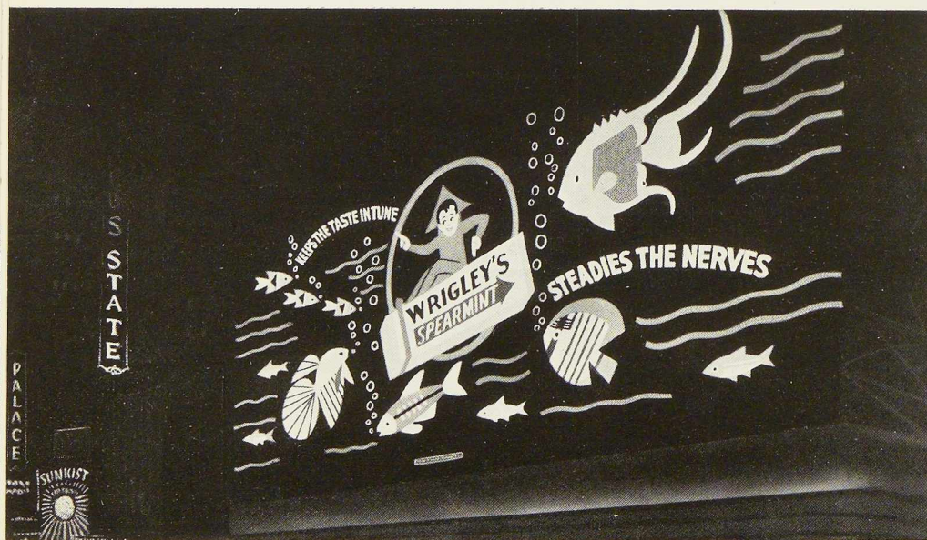
Fig. 718. La plus grande enseigne lumineuse du monde, située au Times Square à New-York. Elle comporte 330 mètres courants de tubes au Néon et 29.508 sockets pour lampes.
