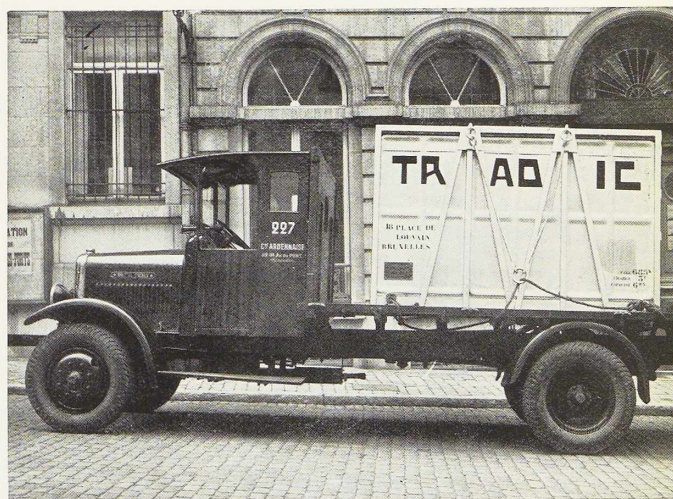
Fig. 140. Container du Syndicat des Transports Directs par Cadres, chargés sur un camion.
