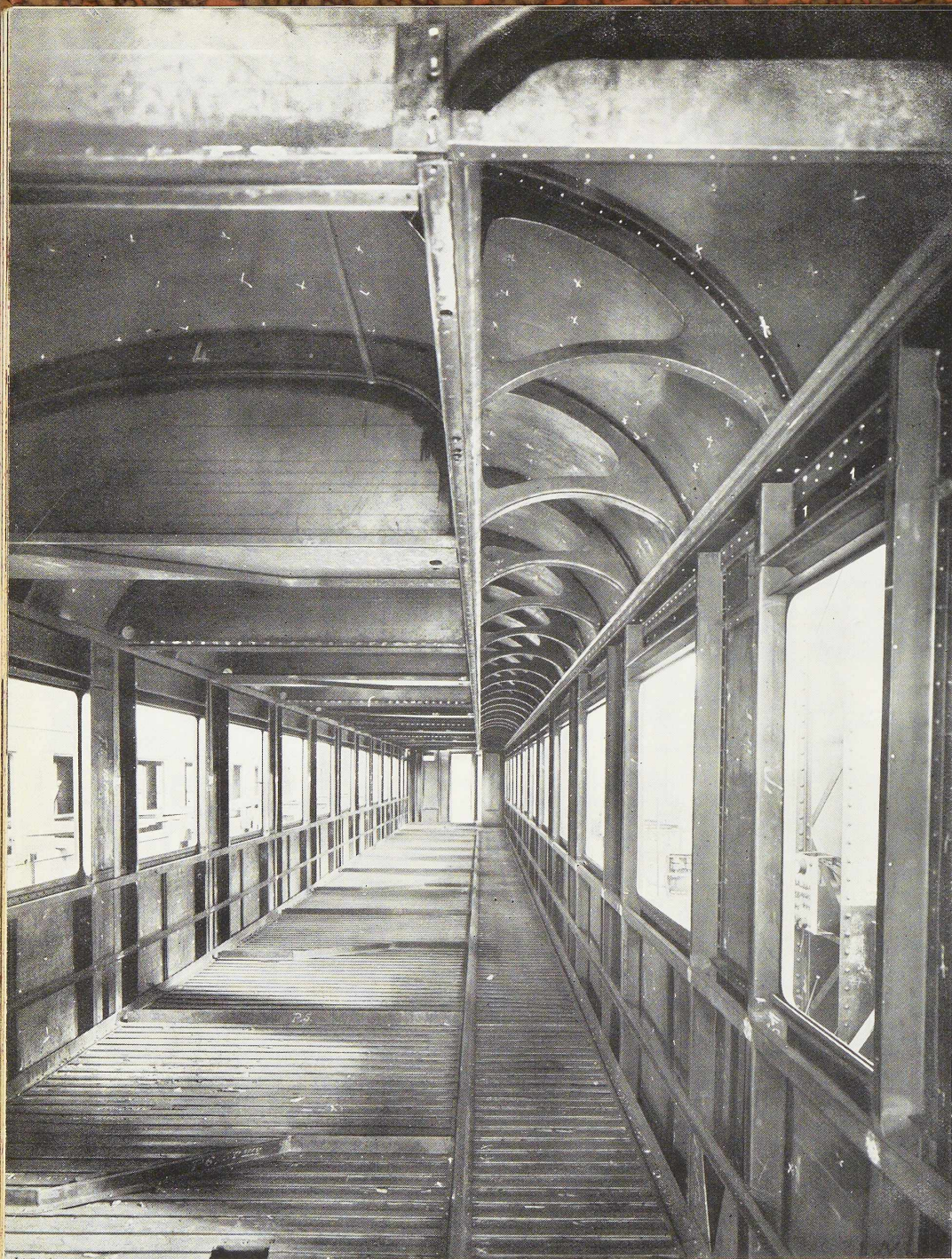
Fig. 57. Vue intérieure de la carcasse d'une voiture métallique de la Compagnie des Wagons-lits, avant la pose des cloisons.
