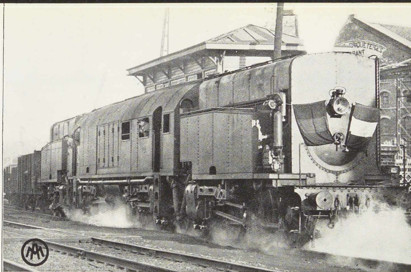
Fig. 61. Locomotive « Franco » à marchandises de 3.000 chevaux construite par la Division Locomotives de Tubize de la S. A. « Les Ateliers Métallurgiques », Nivelles.
