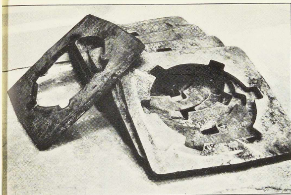
Fig. 654. Plateaux de serrage pour transformateurs (A. C. E. C.) découpés à la coupeuse automatique. Epaisseur : 30 mm. Longueur de coupe : 3,9 mètres. Temps de coupe : 23 minutes.
