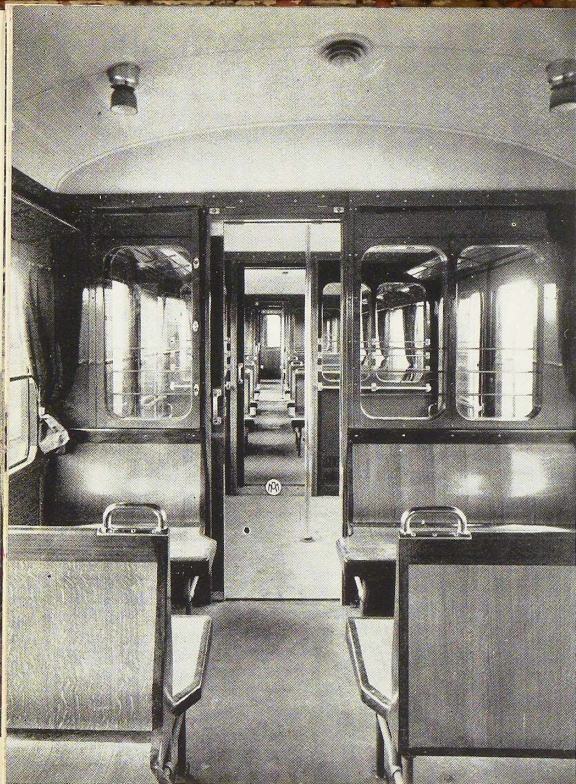
Fig. 643. Intérieur d'une voiture métallique de 3 e classe pour service de banlieue de la S. N. C. F. B. Banquettes en tubes laqués, chêne et teck. Glaces en verre de sécurité. Constructeur : Ateliers Métallurgiques, S. A.
