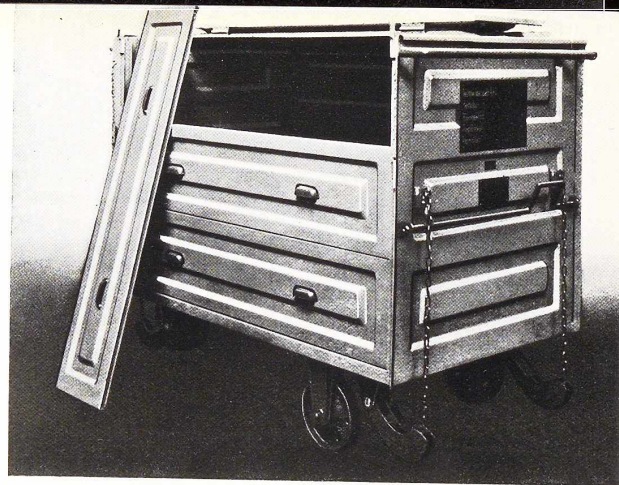
Fig. 127. Container léger tout acier en service sur les chemins de fer allemands.
