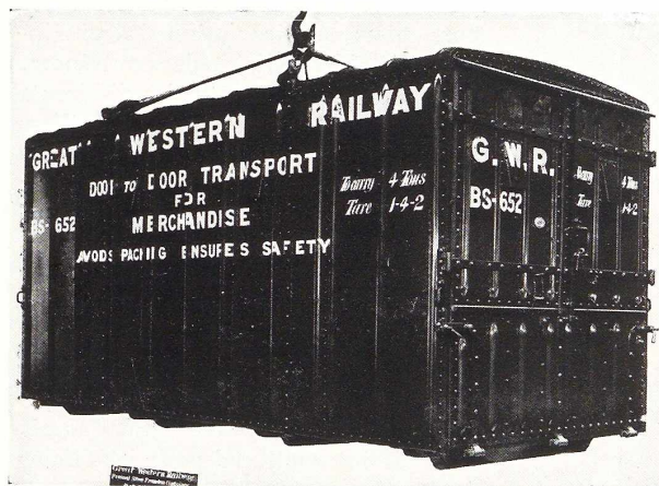
Fig. 120. Container fermé de 4 tonnes de capacité de la Great Western Railway.
