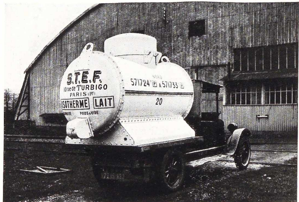
Fig. 109 et 110. Transport conjugué par chemin de fer et par route au moyen de containers isothermes.
