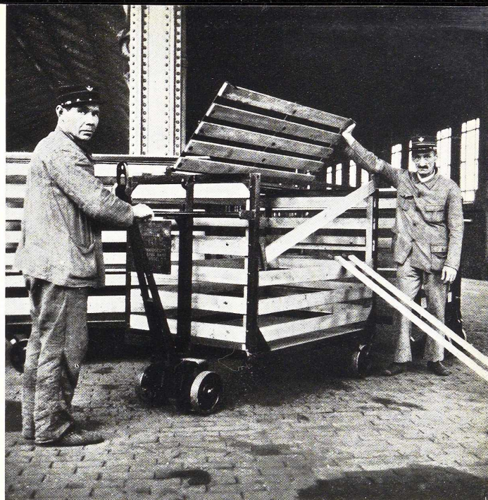
Fig. 129. Un container léger à cadre en acier et parois à claire voie, récemment mis en service par la Société Nationale des Chemins de Fer Belges.
