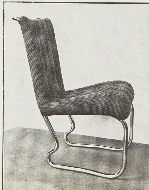
Fig. 61. Siège pour autobus avec rembourrage. Poids : 4,5 kg. Construit par la firme Simon-Mottart, Seraing. Les tubes ont été fournis par la S. A. des Tubes de la Meuse, à Flémalle.
